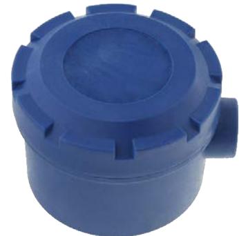
C. 聚丙烯接線盒 材質：聚丙烯(耐酸鹼) 防護等級：IP65 出線端子數：2~12 耐溫：-20~80 °C
