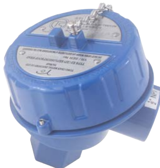
G. 鋁合金防爆接線盒 防爆認證：ATEX/FM/TS 防爆等級：※1 材質：鋁合金烤漆 防護等級：IP68 出線端子數：2~6 耐溫：-20~150 °C
