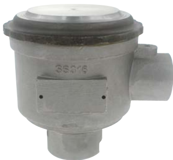
E. 不鏽鋼接線盒 材質：不鏽鋼 SUS316 防護等級：IP65 出線端子數：2~12 耐溫：-20~200 °C
