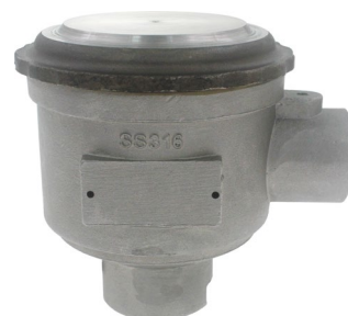
E. TBT 不鏽鋼接線盒 材質：不鏽鋼 SUS316 防護等級：IP65 出線端子數：2~12 耐溫：-20~200 ℃
