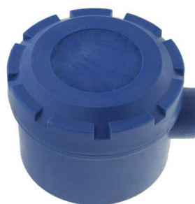
C. 聚丙烯接線盒 材質：聚丙烯(耐酸鹼) 防護等級：IP65 出線端子數：2~12 耐溫：-20~80 ℃
