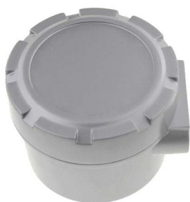
B. 鋁合金接線盒 材質：鋁合金烤漆 防護等級：IP65 出線端子數：2~12 耐溫：-20~200 ℃
