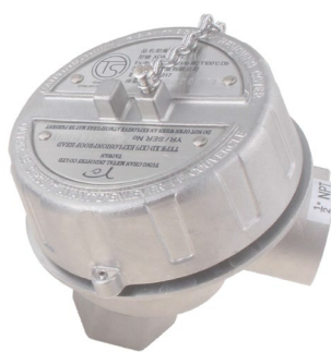
H. 不鏽鋼防爆接線盒 防爆認證：ATEX/FM/TS 防爆等級：※2 材質：不鏽鋼 SUS316 防護等級：IP68 出線端子數：2~6 耐溫：-20~150 ℃
