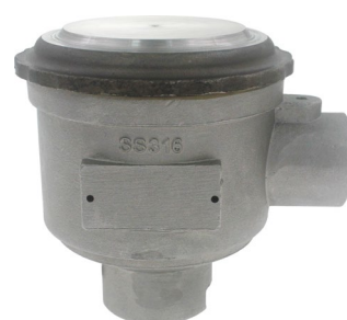
E. TBT 不锈钢接线盒 材质：不锈钢 SUS316 防护等级：IP65 出线端子数：2~12 耐温：-20~200 ℃
