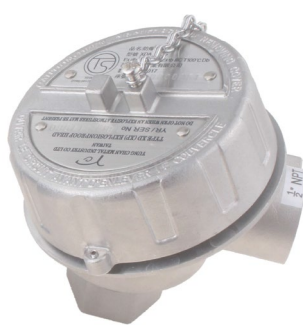
H. 不锈钢防爆接线盒 防爆认证：ATEX/FM/TS 防爆等级：※2 材质：不锈钢 SUS316 防护等级：IP68 出线端子数：2~6 耐温：-20~150 ℃
