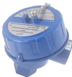
G. 铝合金防爆接线盒 防爆认证：ATEX/FM/TS 防爆等级：※1 材质：铝合金烤漆 防护等级：IP68 出线端子数：2~6 耐温：-20~150 ℃
