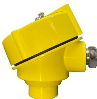
A. TBT 铝合金接线盒 材质：铝合金 防护等级：IP65 出线端子数：2~6 耐温：-20~200 ℃
